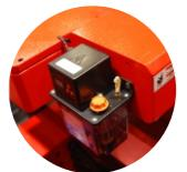
Система смазки с автоматической подачей в линейные подшипники
