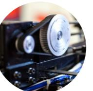
Редукторная передача для более точного позиционирования режущей головки
